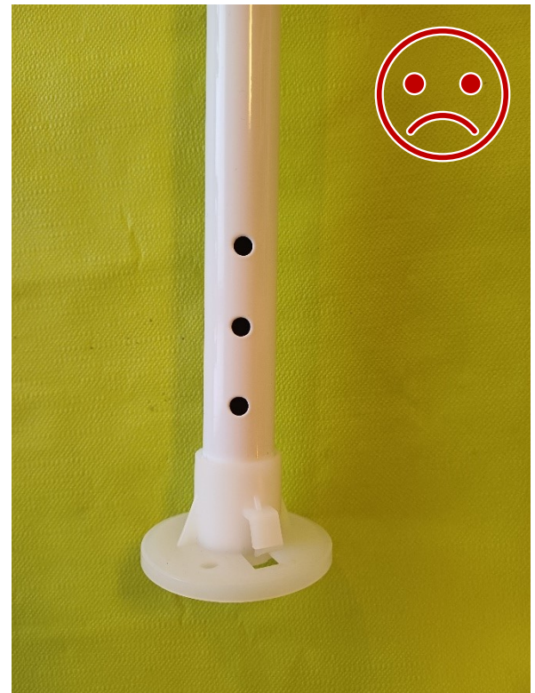
Kuva 14 Ei NÄIN. Kuluttajakäyttöön tarkoitettu rakenne. Muovinen tukijalka ei ole lukittu tolppaan, eikä kestä rasitusta.
