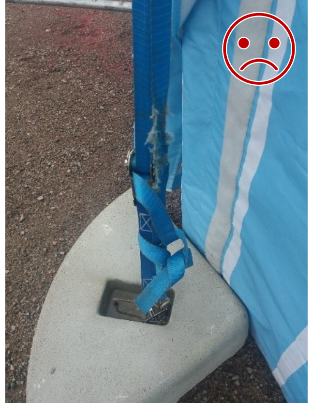
Kuva 10 EI NÄIN. Kuormaliina on kulunut.
